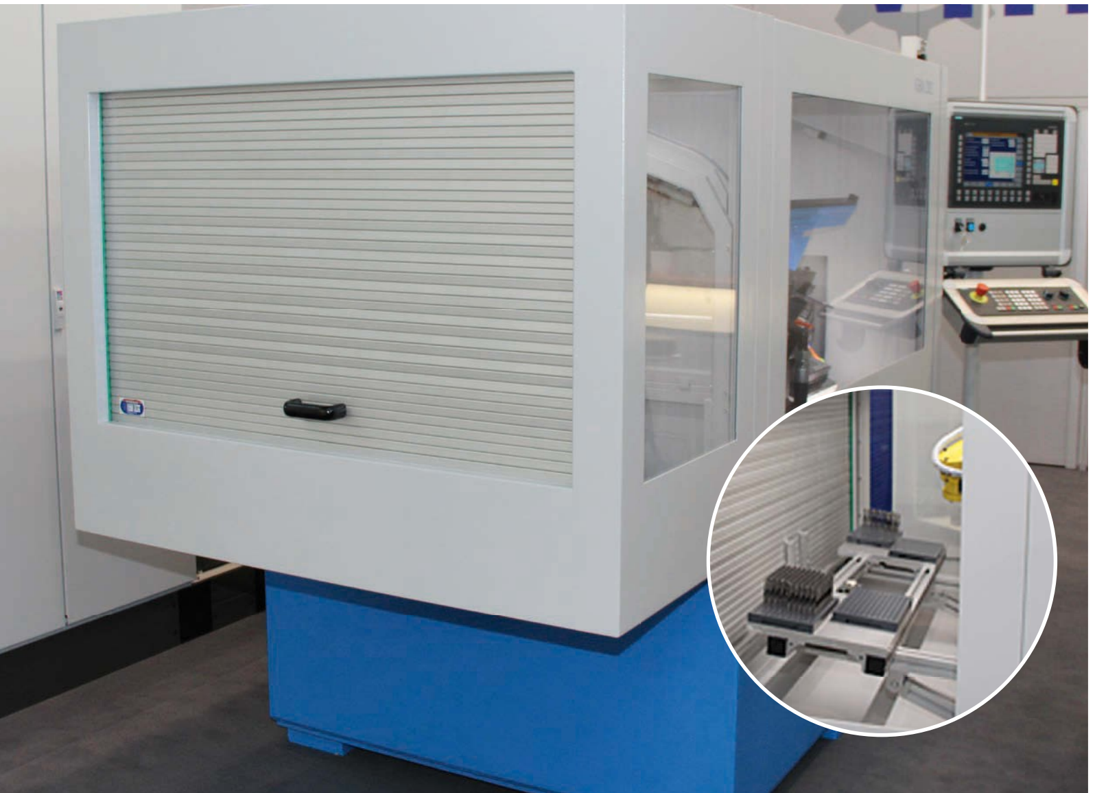
Manuell betätigtes Rolltorsystem auf Basis der Gliederschürze Ausführung 2N.
