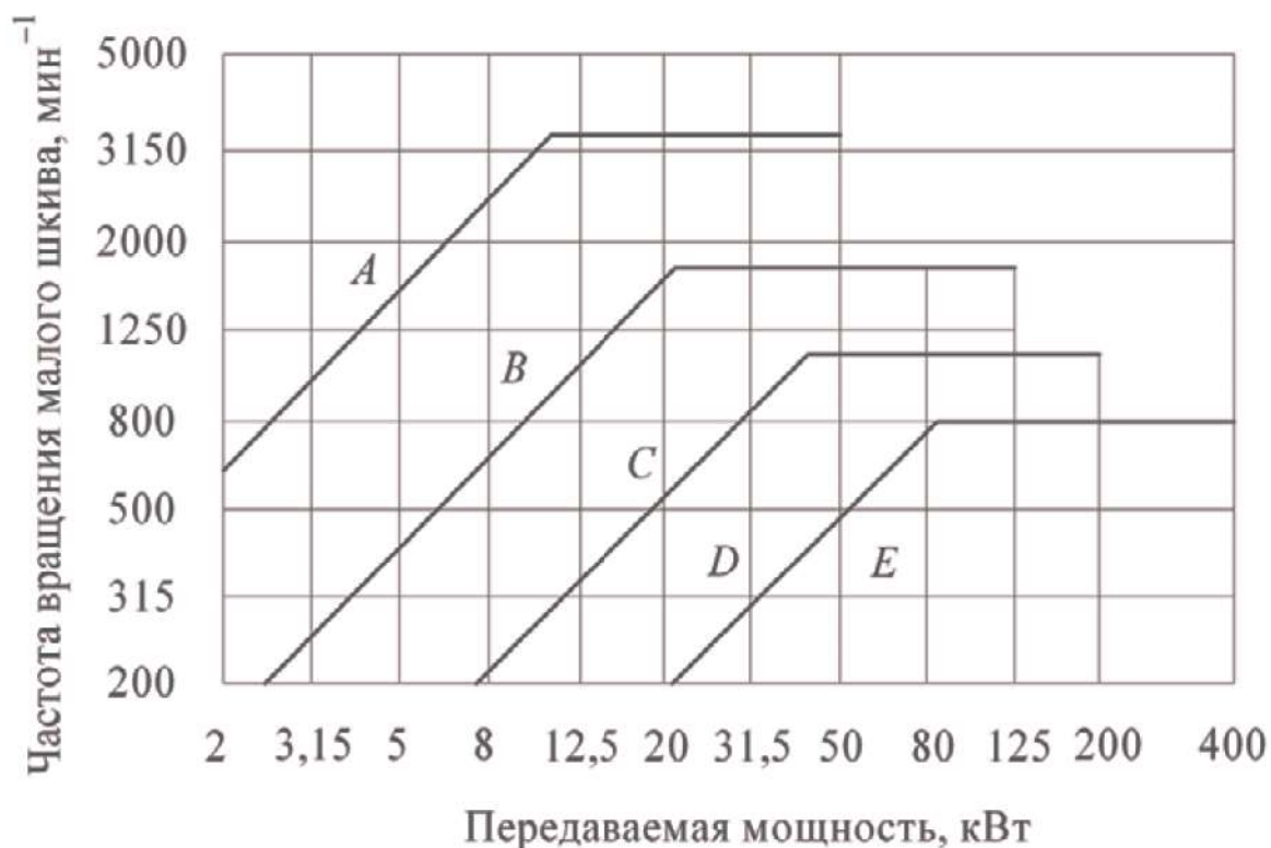
Рис. 18. Диаграмма для выбора сечения клинового ремня
